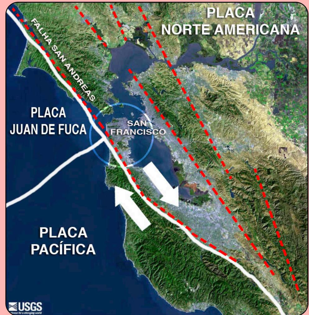
A Falha de San Andreas ocupa uma extensão de cerca de 1.300 quilômetros ao longo da Califórnia, e marca a zona de contato onde a Placa Pacífica e a Placa Norte Americana deslizam em sentidos opostos, desde 10 milhões de anos. Esse longo tempo de movimento foi suficiente para colocar lado a lado blocos de terreno com características litológicas completamente diversas, em função do deslocamento lateral entre as placas.
