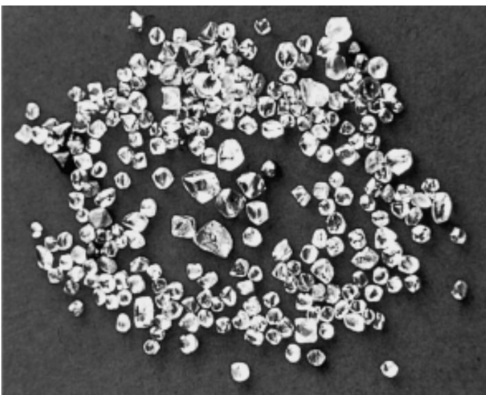
Figura 2. Imagens de uma parte do segundo lote de diamantes produzido e comercializado. Segundo os técnicos que tiveram acesso naquele período, diamantes com hábito octaédrico eram comuns, mas não predominantes. A maior parte apresentava hábitos “arredondados”, provavelmente rombododecaedros e outras formas transicionais. Foto: Paulo Manzig – 1985.
