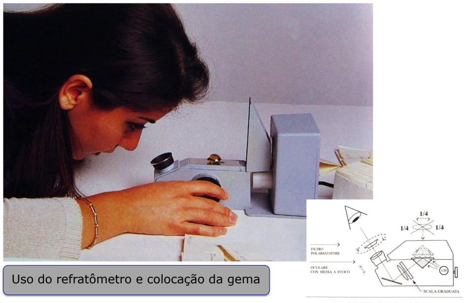
Fig. 74 - Schema di funzionamento del rifrattometro
